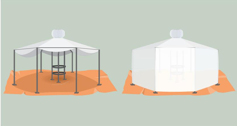
Equipamento aperfeiçoado através de pesquisas realizadas pela Universidade Federal do Piauí. O secador solar é um equipamento montado em uma estrutura metálica cujas paredes laterais e cobertura são feitas de plástico flexível e resistente ao vento, chuva e temperaturas elevadas. Na cobertura é colocado um exaustor e o piso de dentro é recoberto com lona plástica.
