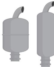
Silenciador no escapamento da máquina a fim de atenuar o ruído e preservar a audição dos trabalhadores.
